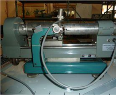
Chambre de Weissenberg avec connexion pour caméra
