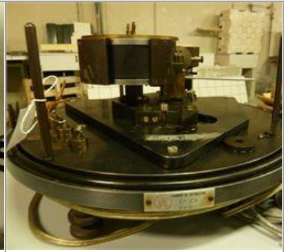
Chambre de Debye-Scherrer (sans la cloche de confinement en verre)
