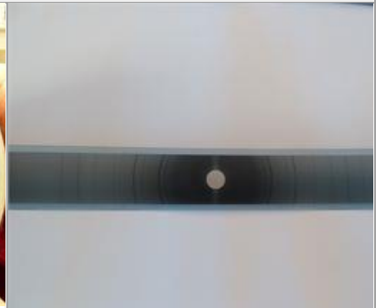
Diffractogramme en cercles concentriques (détail)
