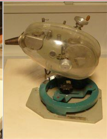
Chambre de Guinier-De Wolff avec capot de confinement en plexiglas
