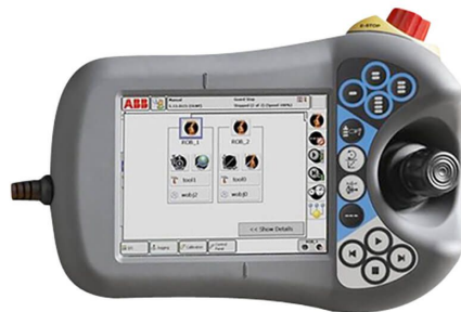
FIGURE 15 – Boîtier de commande de la marque ABB, aussi appelé FlexPendant.
