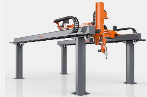
Portique de découpe au laser Kuka KR70LP
