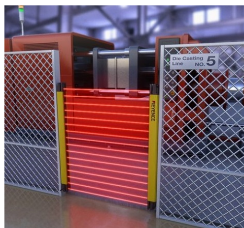
FIGURE 14 – Vue d'artiste d'une barrière immatérielle (les faisceaux sont normalement invisibles en l'absence de poussières.)
