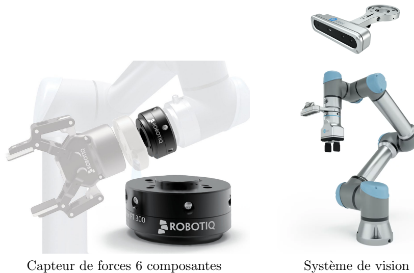
FIGURE 11 – Exemples de capteurs adaptés à des bras robotisés développés par Robotiq et OnRobot.
