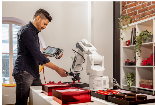
FIGURE 16 – Enregistrement manuel d'une position d'un robot ABB.
