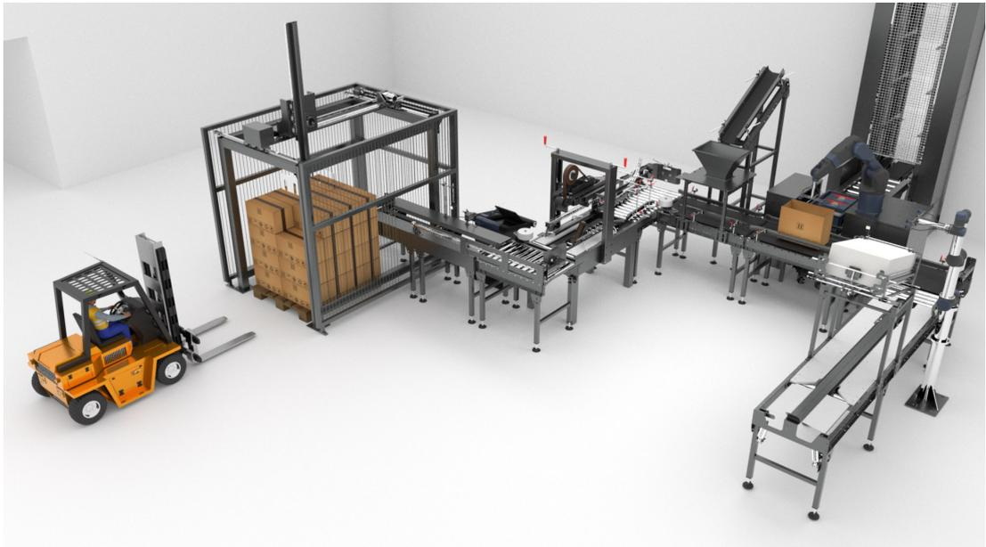
FIGURE 1 – Exemple de ligne de montage automatisée permettant l'encartonnage de paquets.
