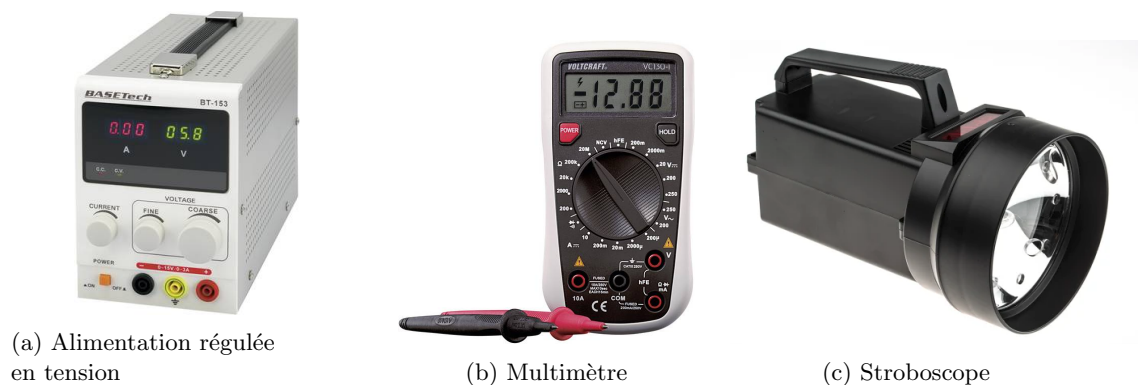
FIGURE 1 – Matériel utilisé pour la caractérisation d'un moteur à courant continu.
