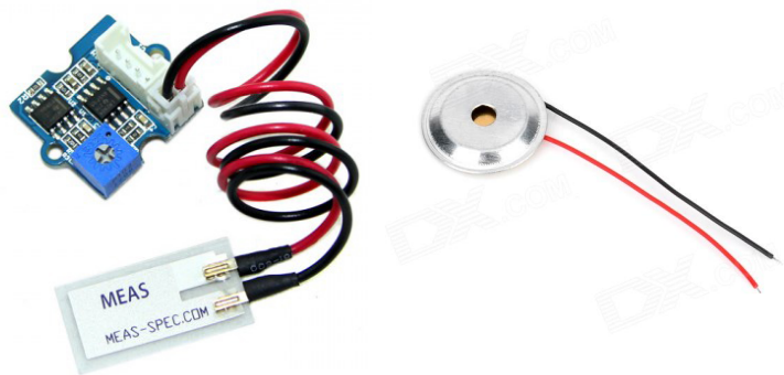
FIGURE 1.4 – Exemples de capteurs piézoélectriques utilisés pour étudier des phénomènes physiques tels que les vibrations.
