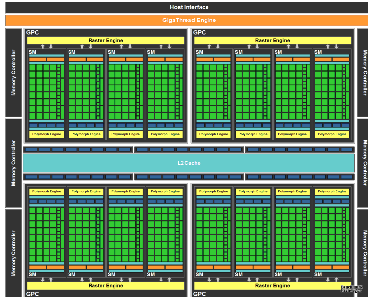
FIGURE 3.5 – Architecture physique du GPU GF100 fabriqué par Nvidia.
