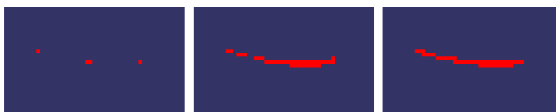
FIGURE 2.8 – Empreinte d'une surface tessellée sous forme d'un maillage et rastérisé par le GPU. A gauche : mode plein. Les fragments affectés par la rastérisation laisse une empreinte discontinue à l'écran, puisque seuls 4 fragments ont leur centre tombant véritablement dans l'enceinte des triangles tessellés (Partie I, Figure 3.4). Le rendu obtenu est montré sur la Figure 2.7. Au centre : rendu en utilisant 4 échantillons par fragment. L'empreinte est toujours discontinue. A droite : le mode fil de fer laisse une empreinte de fragments continue, comme nous le voulons.
