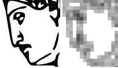
FIGURE 3.13 – A gauche : rendu basé chemin restreint à chaque cellule pour Nehab et Hoppe [NH08], effectué avec un nombre variable de primitives par cellule. A droite : quantité d'informations présentes dans chaque cellule (plus foncé signifie un nombre d'informations accru).
